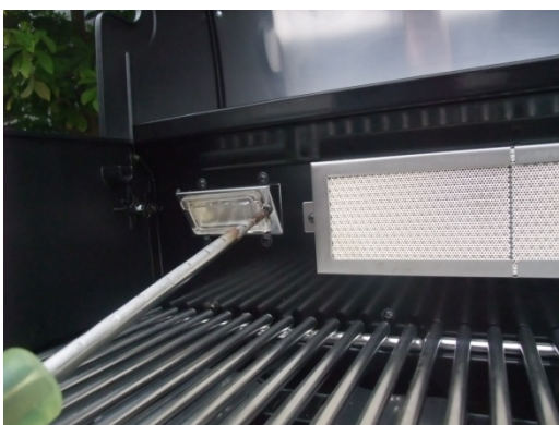
3. Retire el tornillo y la tuerca que sostienen la caja del bulbo en su lugar.
