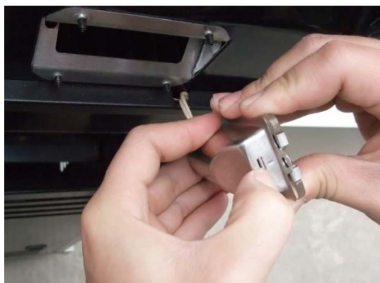
5. Presione el botón en el extremo de la caja del bulbo para liberar y quitar el vidrio de la caja de la bombilla.
