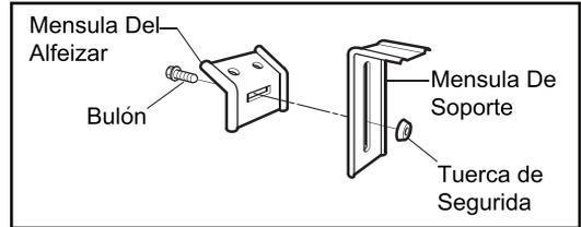
2. Coloque la ménsula del alféizar en el alféizar de la ventana utilizando los tornillos (Tipo B). Apriete el perno y la tuerca de seguridad. Repisa de la ventana y alinee la marca central en el frente del fondo con la línea central marcada en la repisa de la ventana.
