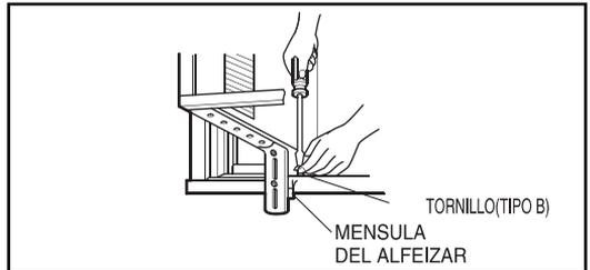
3. Utilizando el tornillo M y la tuerca de seguridad, coloque la ménsula de soporte en el orificio de la guía del gabinete. Use el primer orificio de la guía después de la ménsula del alféizar en el borde exterior del alféizar de la ventana.
