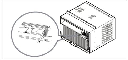
9. Corte el aislamiento de espuma con adhesivo en la parte trasera del tamaño del panel guía.
