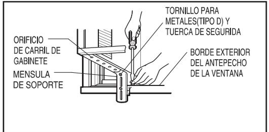
4. Apriete el perno y la tuerca de seguridad. Asegúrese de que el gabinete esté inclinado hacia afuera.
