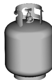
Tanque de gas en posición vertical para extraer el vapor
