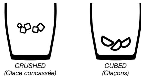
Pour de la glace concassée, les glaçons sont concassés avant d'être distribués. Cette action peut causer un court délai lors de la distribution de glace concassée. Le bruit du broyeur de glaçons est normal et la dimension des morceaux de glace peut varier. Lorsqu'on passe du mode glace concassée au mode glaçons, quelques onces de glace concassée sont distribuées avec les premiers glaçons.
