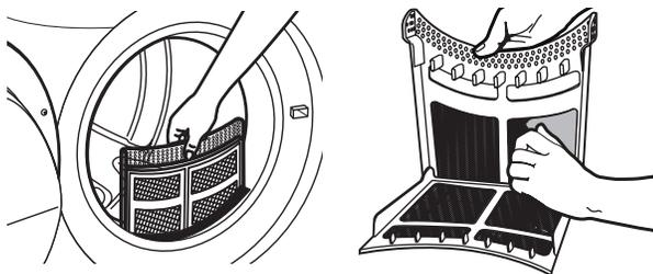
2. Fermer le filtre à charpie. Remettre le filtre à charpie fermement en place.
