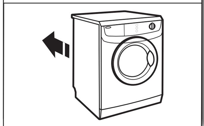
Placer la sècheuse à son emplacement final en prenant soin de ne pas écraser ou déformer le conduit d'évacuation. Une fois la sècheuse en place, retirer les cornières et le carton sous la sècheuse.
