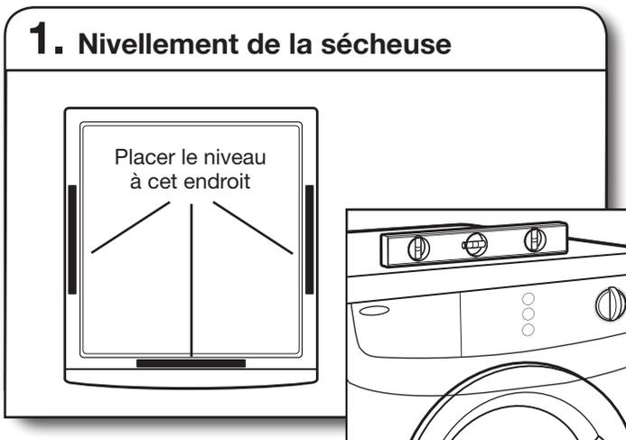
Vérifier l'aplomb de la sécheuse dans le sens transversal. Répéter l'opération dans le sens avant-arrière.
