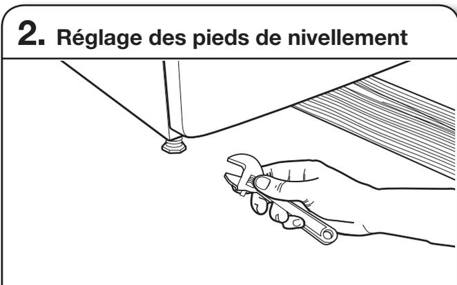
Si la sécheuse n'est pas d'aplomb, la soulever à l'aide d'une cale en bois à l'aide d'une clé pour ajuster les pieds vers le haut ou vers le bas et contrôler de nouveau l'aplomb. Une fois la sécheuse d'aplomb, s'assurer que les quatre pieds sont en contact ferme avec le plancher et que la sécheuse ne tanguent pas.
