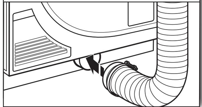
À l'aide d'une bride de fixation de 4" (102 mm), relier le conduit d'évacuation à la bouche d'évacuation de la sècheuse. Si l'on réalise le raccordement au conduit d'évacuation existant, s'assurer que celui-ci est propre. Le conduit d'évacuation doit être fixé par-dessus la bouche d'évacuation de la sècheuse et à l'intérieur du clapet d'évacuation. S'assurer que le conduit d'évacuation est fixé au clapet d'évacuation à l'aide d'une bride de fixation de 4" (102 mm).
