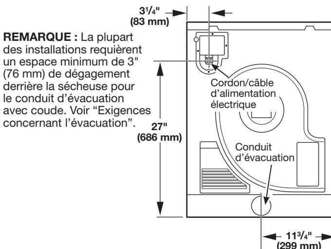
**REMARQUE :** La plupart des installations requièrent un espace minimum de 3" (76 mm) de dégagement derrière la sècheuse pour le conduit d'évacuation avec coude. Voir "Exigences concernant l'évacuation".
