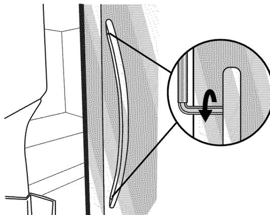
5. Serrer la vis de blocage jusqu'à ce qu'elle commence à toucher la vis à épaulement en la tournant dans le sens horaire. Ne pas serrer complètement.
