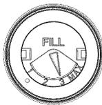
Tourner le régleur à flèche à l'intérieur du distributeur pour modifier le réglage de l'agent de rinçage.
