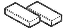
Bloques de relleno o de madera sobrante, si fueran necesarios para el espacio del gabinete superior (se utilizan solamente en instalaciones de gabinetes con la superficie inferior hueca)
