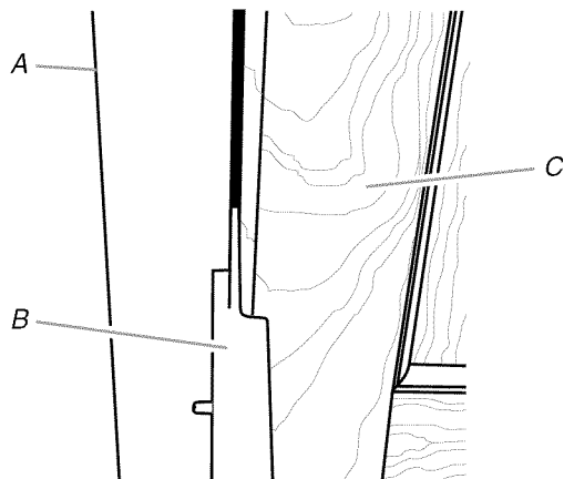
A. Armoires adjacentes B. Cale d'installation C. Panneau sur porte
