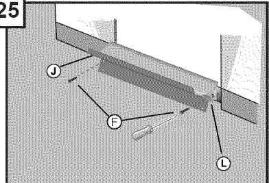
Glissez la vis (pièce F), du côté droit en premier, à travers le trou supérieur du panneau de plancher en plastique (pièce J), placez la rondelle (pièce L) à l'extrémité de la vis et fixez le panneau de plancher au lave-vaisselle en serrant la vis. Répétez ces étapes pour le côté gauche.
