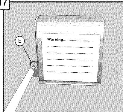
Replacer le couvercle de la boîte de jonction. S'assurer qu'il soit bien placé derrière la face avant de la plaque du réducteur de tension. Fixer la plaque grâce à la vis (pièce E du kit d'installation).
