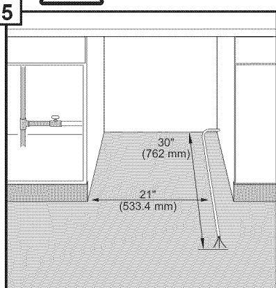
Corte la energía eléctrica en la caja de fusibles. Independientemente de donde se origine el cable de suministro eléctrico, colóquelo a 21" (533.4 mm) del lado izquierdo de la abertura. Extienda el cable 30" (762 mm) desde la pared trasera.
