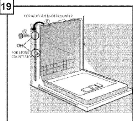
Si votre comptoir est en pierre, détacher les supports de montage (A) par le haut et leur position à chaque points sur le côté. Introduire la vis (B) par le biais de pré-supports situés de chaque côté de l'unité et fixez les supports.
