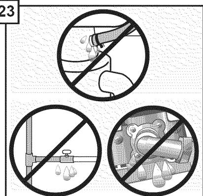
Una la línea del agua a la válvula de apagado del agua caliente. Prenda el agua y revise si hay fugas. Encienda la energía eléctrica en la caja de fusibles. Encienda el lavavajillas, escuche el agua y la bomba de distribución de agua. Prena cancele/Remette à l'état initial, a drene y revise si hay fugas.
