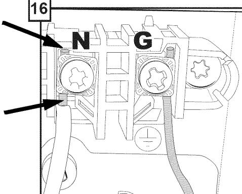
Cerciórese de que la porción expuesta (no-aislada) de cada alambre pelado aparezca sobre y debajo del tornillo terminal. Apriete con seguridad los tornillos terminales, pero no **los sobre apriete** pues esto puede ocasionar daños.
