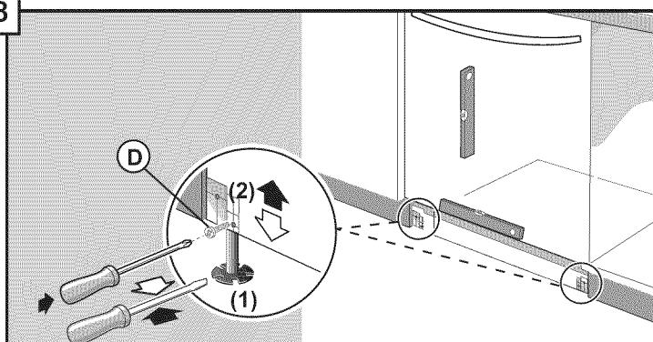
Mettre le lave-vaisselle horizontalement à niveau le lave-vaisselle en tournant les nivelleurs des pieds avant (1) dans le sens des aiguilles d'une montre pour soulever la partie avant du lave-vaisselle ou dans le sens inverse des aiguilles d'une montre pour l'abaisser. Une fois que le lave-vaisselle est bien stable, (2) placer et visser la vis (D) qui permettra de bloquer définitivement le niveau choisi.
