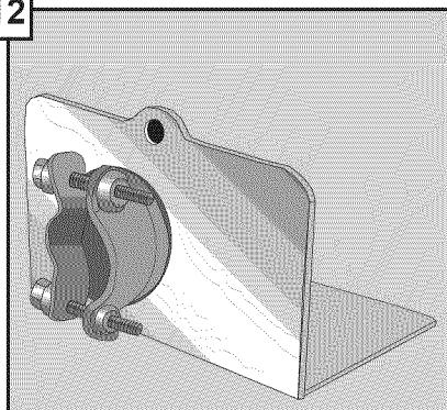
Una de sujetacables (no incluido) a la placa del sujetacables. Los dos tornillos en la parte trasera del sujetacables se deben colocar según lo demostrado para prevenir interferencias durante el montaje. Apriete la tuerca de fijación del sujetacables para evitar que éste gire.
