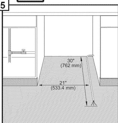
Couper le courant électrique qui doit alimenter le lave-vaisselle. Indépendamment d'où vient le câble électrique, il faut le placer à 21 po (533.4 mm) de distance du côté gauche de l'emplacement réservé au lave-vaisselle et le faire courir sur 30 po (762 mm) depuis le mur du fond.
