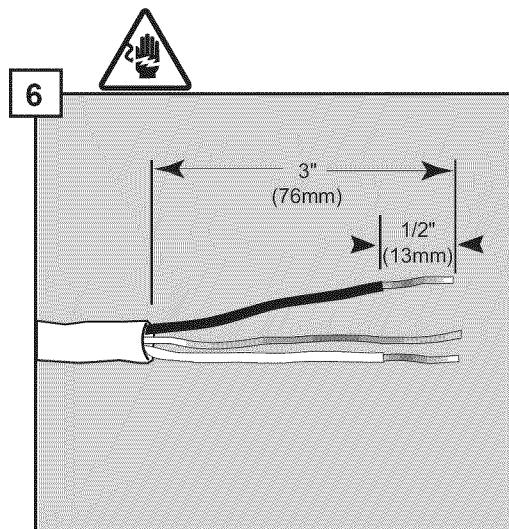
Dénuder le câble électrique de 3 po (76 mm) afin de faire apparaître les fils électriques intérieurs.
