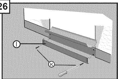
Fixez les vis (pièce K) à travers le panneau de plancher métallique (pièce I) aux trous inférieurs du panneau de plancher en plastique de façon à ce qu'il soit au niveau avec le plancher.
