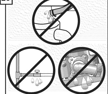
Relier le tuyau d'alimentation en eau à la valve d'arrivée d'eau chaude. Faire couler l'eau et vérifier qu'il n'y ait pas de fuite. Rétablir le courant électrique. Démarrer le lavage, écouter l'eau affluée et la pompe de distribution de l'eau. Presser arrêter la vidange/Reponga et vérifier qu'il n'y ait pas de fuite.
