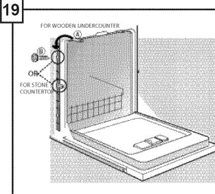
Si la encimera es de piedra, extraiga los soportes de montaje (A) de la parte superior y la posición de ellos en cualquiera de los puntos en el lateral. Inserte el tornillo (B) a través de pre-soportes colocados a cada lado de la unidad y fije los soportes.
