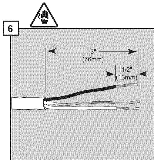
Pele la cubierta externa del alambre eléctrico para exponer 3" (76 mm) de los alambres internos. Después pele 1/2" (12.7 mm) de la cubierta de cada alambre individual.\*
