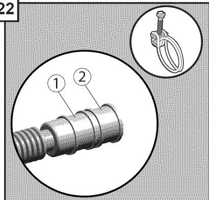
Conecte el desaguadero manga a la plomería con abrazadera de tornillo (posicione 1 para 1/2" o posicione 2 para 3/4") y apriete. No corte manga de desaguadero.
