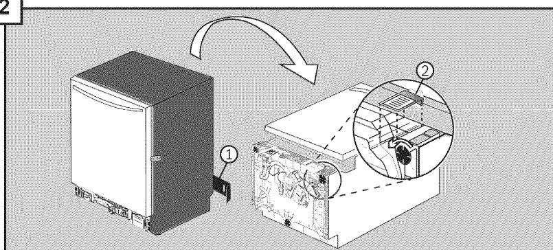
Coloque el lavavajillas suavemente sobre la parte trasera. Remueva el panel de la base. Afloje ligeramente los niveladores de la pata (2). Remueva la cubierta de la caja de conexiones y guárdela para uso posterior.
