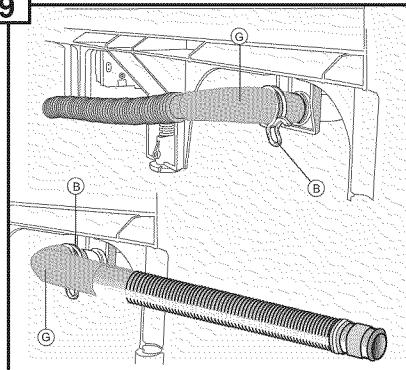
Orienter le tuyau vers la direction d'évier. **IMPORTANT** : Le tuyau de route vers l'évier AVANT la connexion. Ne pas tourner après attachement. Connectez le tuyau de vidange (G) au dos de lave-vaisselle en utilisant des pinces pour serrer la pince (B).
