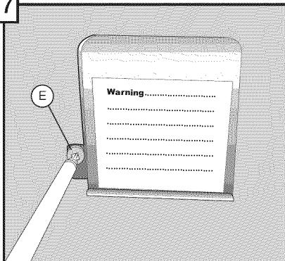
Coloque la cubierta de la caja de conexiones. Cerciórese de que la cubierta esté asentada detrás del borde delantero de la placa del sujetacables. Una la cubierta con el tornillo (parte E) del equipo de instalación.
