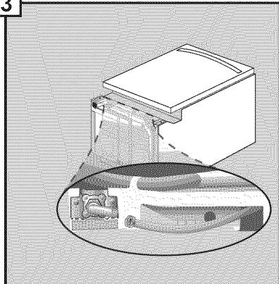
Fixer le raccord coude 90° au lave-vaisselle en l'orientant comme indiqué sur le schéma. Ne pas trop serrer.
