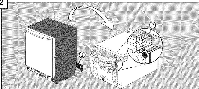
Coucher le lave-vaisselle sur sa partie arrière. Retirer le panneau inférieur. Desserrer les niveleurs des pieds (2). Enlever le couvercle de la boîte de jonction et le mettre de côté pour pouvoir le replacer plus tard.
