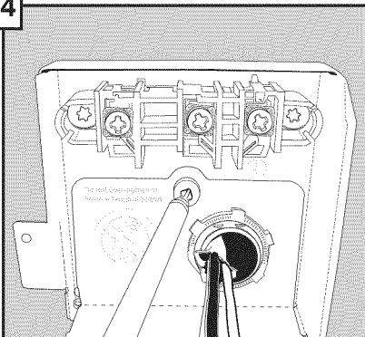
Replacer alors la plaque du réducteur de tension dans la boîte de jonction et replacer la vis. S'assurer que l'étiquette située en bas de la plaque se trouve à l'extérieur de la boîte de jonction au moment de l'assemblage.
