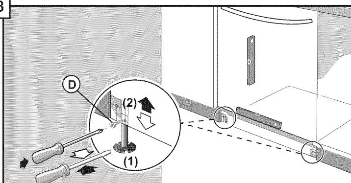
Nivele el lavavajillas horizontalmente girando los pies (1) en sentido de las manecillas del reloj (derecha) para levantar o en sentido opuesto (izquierda) para bajar la parte frontal de la unidad. Una vez nivelado, (2) inserte los tornillos de la pata niveladora (parte D) y apriete.
