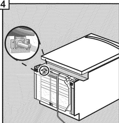
Una la línea del agua caliente al codo de 90° y diríjala debajo de la máquina hacia la unión de agua caliente. Asegúrese que la manguera no tenga contacto con las partes sueltas debajo de la unidad.
