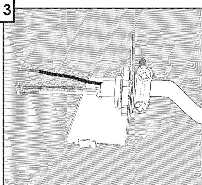
Pase los cables a través del sujetacables y la placa. Apriete la abrazadera alrededor de los cables, orientada como se demuestra. Doble el extremo del cable eléctrico como se demuestra. Esto ayudará a la instalación de la placa del sujetacables más adelante.
