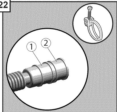
Attacher le tuyau d'égout la plomberie avec le serre-joint de vis (dispose 1 pour 1/2" ou dispose 2 pour 3/4") et resserrer. Ne pas couper le tuyau d'égout.
