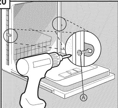
Placer les vis (pièces A du kit d'installation) dans les fixations et visser afin que le lave-vaisselle soit solidement fixer au plan de travail (il est recommandé de percer préalablement les trous dans le plan de travail). Enlever la grille supérieure avant d'insérer les vis.
