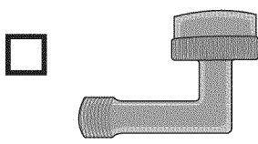
**Acoplador acodado de 90°** con rosca exterior hembra de 3/4" N.P.T. en una extremidad, y en la otra extremidad del tamaño adecuado para poder conectarlo a la alimentación de agua (tubo de cobre/accesorios sujetadores de compresión o manguera con alambre trenzado).
