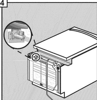
Raccorder le tuyau d'eau chaude au coude 90° et dirigez au-dessous de la machine vers la connexion chaude d'eau. S'assurer que le tuyau n'entre pas en contact avec les pièces mobiles de l'appareil.
