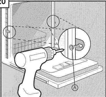
Inserte los tornillos (parte A) a través de los soportes de montaje previamente colocados y coloque la unidad en el recinto (se recomienda taladrar los agujeros previamente). Saque la rejilla superior antes de insertar los tornillos.
