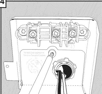
Coloque la placa montada del sujetacables nuevamente dentro de la caja de conexiones y vuelva a fijar el tornillo. Cerciórese de que la lengüeta en el lado derecho de la placa del sujetacables esté fuera de la caja de conexiones mientras la desliza hacia dentro.
