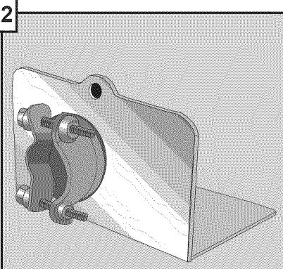
Disposer le réducteur de tension (non inclus) dans la plaque du réducteur de tension. Fixer le réducteur de tension à sa plaque. Les deux vis à l'arrière du réducteur de tension doivent être positionnées comme indiqué sur le schéma afin de prévenir toute interférence pendant l'assemblage. Serrer l'écrou du réducteur de tension afin d'éviter que celui-ci ne bouge.
