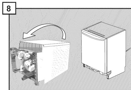
Faire basculer le lave-vaisselle vers l'avant pour qu'il soit à nouveau débout en s'assurant, d'une part, que le tuyau d'alimentation d'eau ne soit pas écrasé et, d'autre part.
