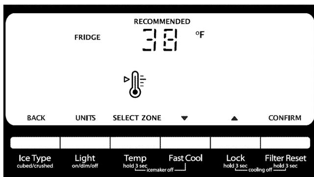
**REMARQUE :** Pour visualiser les températures en Celsius, appuyer sur la touche LIGHT (éclairage) lorsque le mode de réglage est activé. Pour revenir au mode d'affichage en Fahrenheit, appuyer de nouveau sur LIGHT.
