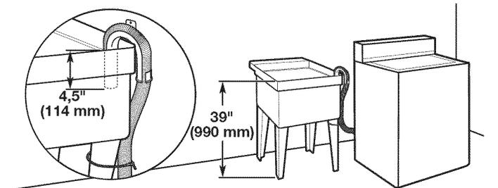
Capacité minimale : 20 gal. (76 L). Le sommet de l'évier de buanderie doit se trouver à au moins 39" (990 mm) du plancher.
