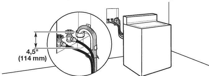
Voir les exigences pour le système de vidange avec tuyau de rejet à l'égout au plancher.
