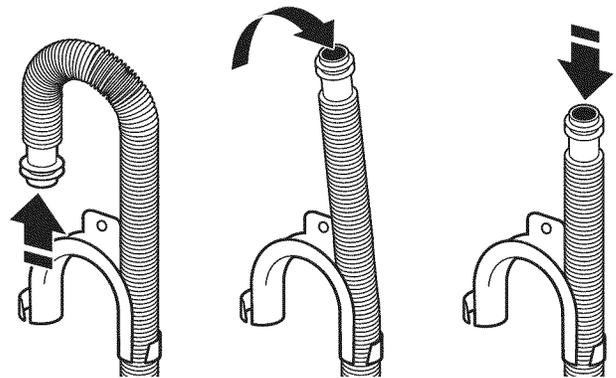
7. Le système de vidange au sol nécessite un brise-siphon qui peut être acheté séparément. Le brise-siphon (pièce numéro 285834) doit se trouver au moins à 28" (710 mm) de la base de la laveuse. Des tuyaux supplémentaires peuvent s'avérer nécessaires.
