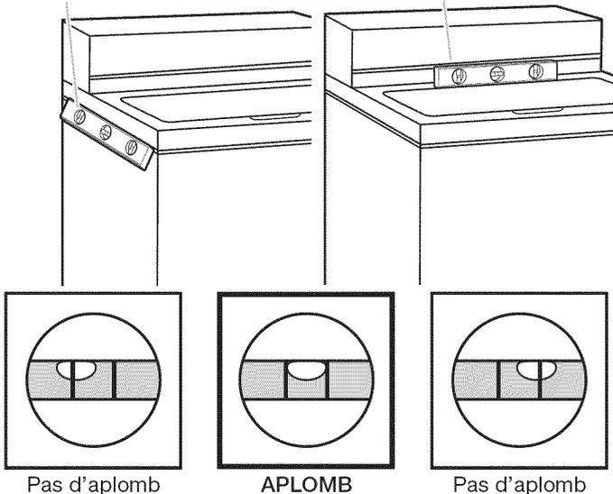
2. Sur les modèles avec les pieds en métal, utiliser une clé plate ou une clé à molette de 9/16" ou 14 mm pour tourner les contre-écrous dans le sens horaire jusqu'à ce qu'ils se trouvent à environ 1/2" (13 mm) de la caisse de la laveuse. Tourner ensuite le pied de nivellement dans le sens horaire pour abaisser la laveuse ou antihoraire pour la soulever.
