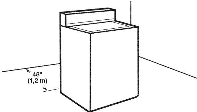
2. Afin d'éviter d'endommager le plancher, placer les supports en carton du carton d'expédition sur le plancher, derrière la laveuse. Incliner la laveuse vers l'arrière et la placer sur les supports en carton. Retirer la base d'expédition. Redresser la laveuse en position verticale.
