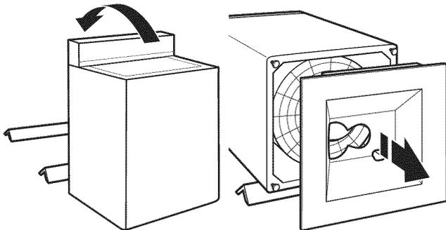
3. Retirer le ruban adhésif du couvercle de la laveuse, ouvrir le couvercle et retirer le carton plat d'emballage de la cuve. Veiller à retirer toutes les pièces du carton plat.
