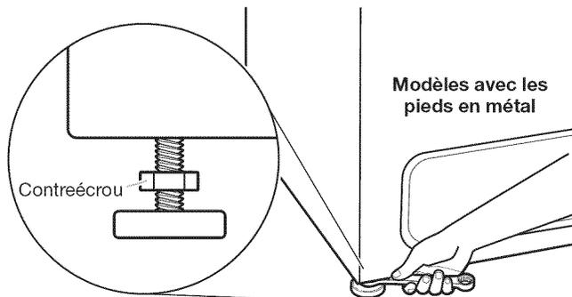
3. Sur les modèles avec les pieds en métal, une fois l'aplomb de la laveuse établi, utiliser une clé plate ou une clé à molette de 9/16" ou 14 mm pour tourner les contre-écrous sur les pieds de nivellement dans le sens anti-horaire et les serrer fermement contre la caisse de la laveuse.
