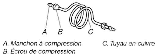
5. Placer l'extrémité libre du tuyau dans un contenant ou évier et rétablir l'alimentation principale en eau pour nettoyer le tuyau jusqu'à ce que l'eau en sorte claire. Fermer le robinet d'arrêt sur le tuyau d'alimentation en eau.
