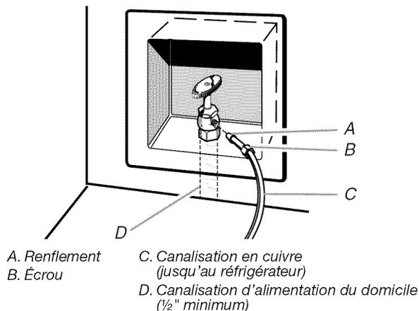
4. On est maintenant prêt à connecter le tuyau en cuivre au robinet d'arrêt. Utiliser un conduit de cuivre flexible de  $\frac{1}{4}$ " (6,35 mm) de diamètre extérieur pour raccorder le robinet d'arrêt au réfrigérateur.
