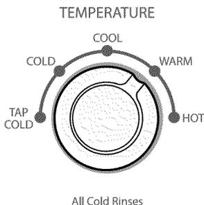
Après avoir sélectionné un programme, sélectionner la température de lavage désirée en tournant le bouton de température.
