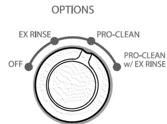
Si l'on souhaite ajouter un rinçage supplémentaire et/ou utiliser l'option Pro-Clean (nettoyage professionnel), tourner le bouton correspondant pour activer cette caractéristique.
