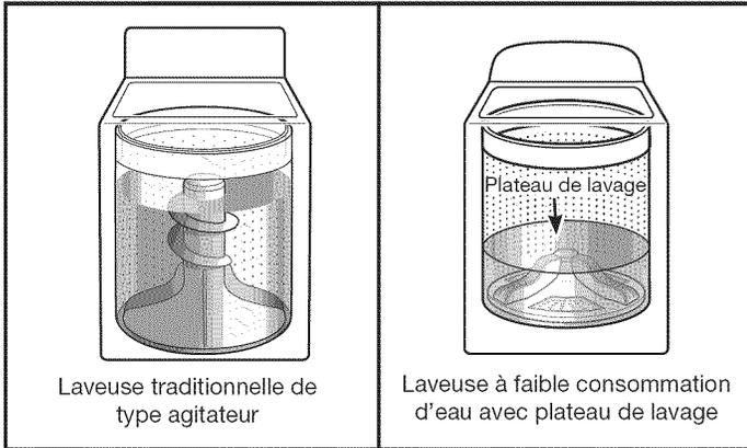
La nouveauté la plus flagrante de cette nouvelle laveuse est son système de lavage à faible consommation d'eau avec plateau de lavage. La laveuse ajuste automatiquement le niveau d'eau en fonction de la taille de la charge — nul besoin de sélecteur de niveau d'eau.
