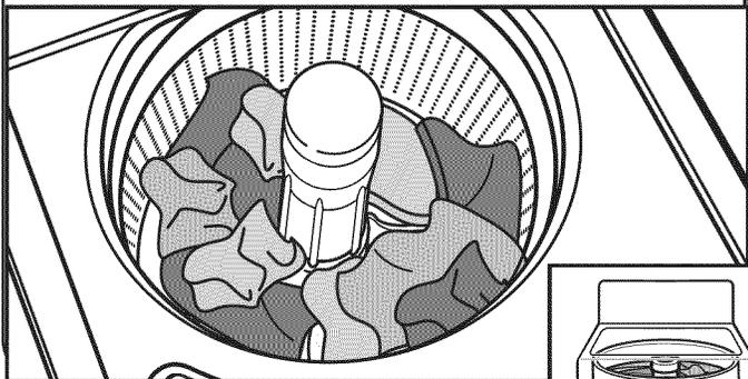
Charger les vêtements sans les tasser et de façon uniforme le long de la paroi du panier. Pour de meilleurs résultats, ne pas remplir au-delà de la hauteur maximale de charge recommandée. Ne pas enrouler de grands articles tels des draps autour de l'agitateur; les charger sans les tasser le long de la paroi du panier. Essayer de mélanger différents types d'articles pour réduire l'emmêlement.
