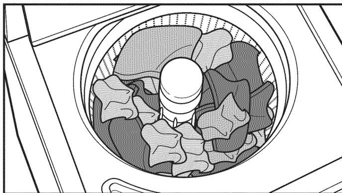
Pour un meilleur rendement, il est recommandé de déposer les vêtements en vrac et de façon uniforme le long du plateau de lavage.
