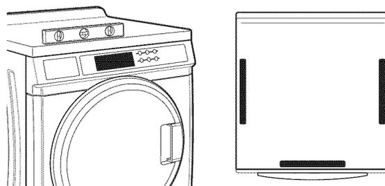
Si la laveuse est placée contre un mur, on doit l'écartier légèrement du mur avant de l'incliner vers l'arrière. Si la laveuse n'est pas d'aplomb, soulever l'avant de la laveuse avec une cale de bois et ajuster la position des pieds selon le besoin; soulever ensuite l'arrière de la laveuse et ajuster la longueur des pieds selon le besoin. Répéter ces opérations jusqu'à l'obtention d'un aplomb correct de la laveuse.
