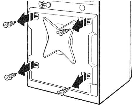
4. Une fois que les 4 boulons ont été retirés, jeter les boulons et les cales d'espacement. Puis remettre le bouchon à l'arrière de la laveuse et tirer le cordon d'alimentation électrique à travers l'ouverture gauche du panneau arrière et obturer le trou avec le bouchon fourni.
