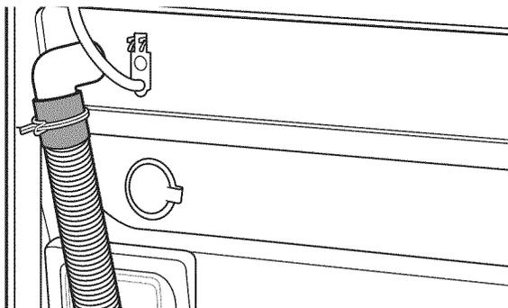
Le système de vidange de la laveuse peut être installé à l'aide d'un conduit d'évacuation au plancher, un tuyau de rejet à l'égout mural (rigide), un tuyau de rejet à l'égout au plancher (rigide) ou un évier de buanderie.
