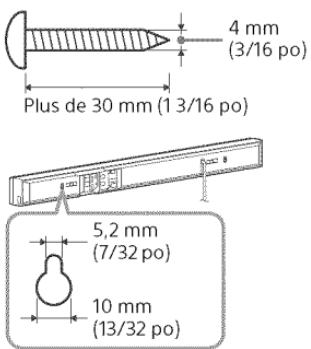
**2** Serrez les vis à deux goujons dans le mur.
