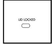
Si necesita abrir la tapa, presione START/PAUSE/Unlock Lid (Inicio/Pausa/Desbloqueo de la tapa). La tapa se desbloqueará una vez que se haya detenido el movimiento de la lavadora. Esto puede tomar varios minutos si la carga estaba exprimiéndose a alta velocidad. Oprima START/PAUSE/Unlock Lid (Inicio/Pausa/Desbloqueo de la tapa) nuevamente para reanudar el ciclo. Evite abrir la tapa durante la detección. El proceso de detección comenzará nuevamente cuando se vuelva a poner en marcha la lavadora.
