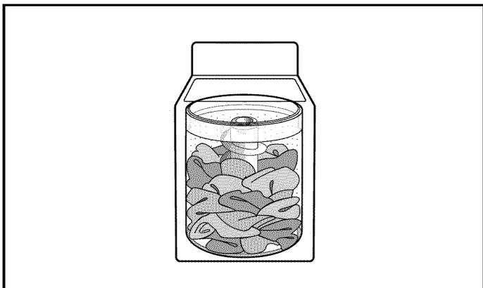
Lorsque l'on charge la laveuse de linge sale, celui-ci doit être réparti uniformément le long des parois du panier.
