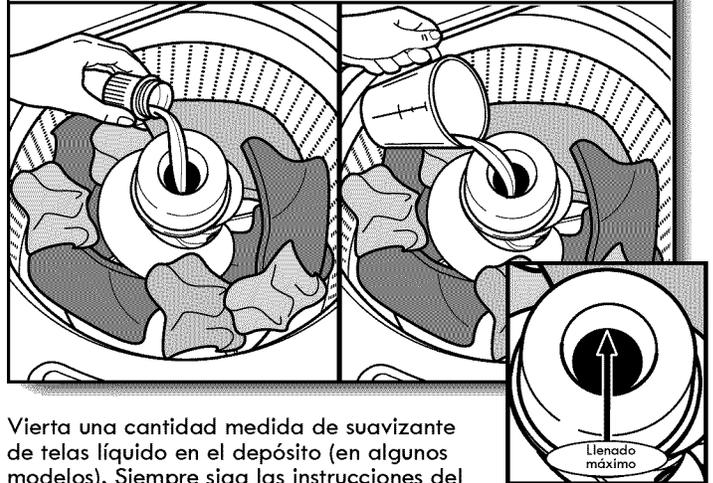
Vierta una cantidad medida de suavizante de telas líquido en el depósito (en algunos modelos). Siempre siga las instrucciones del fabricante para usar la cantidad correcta de suavizante de telas según el tamaño de la carga.
