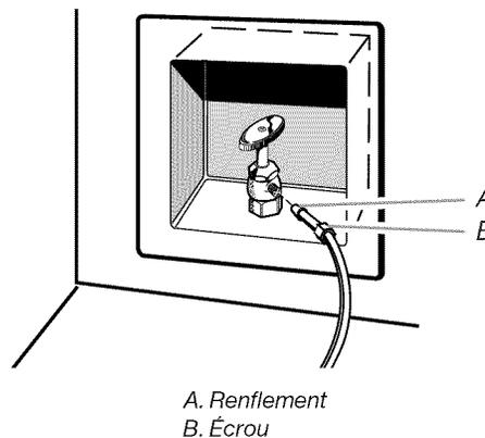
3. On est maintenant prêt à connecter le tuyau en cuivre. Utiliser un tuyau en cuivre souple de 1/4" (6,35 mm) de diamètre extérieur pour l'alimentation en eau froide.
