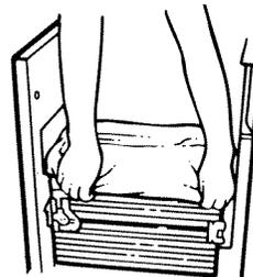
2. Immobiliser le sac en engageant les quatre trous pré-percés sur les boutons de retenue du sac. Les trous s'agrandiront sur les boutons sans endommager le sac.
