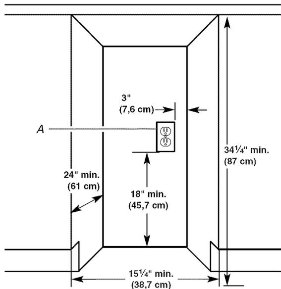
A. La prise électrique reliée à la terre doit être à une distance minimum de 3" (7,6 cm) des armoires voisines ou des murs latéraux tel qu'illustré. Elle peut être placée du côté gauche ou du côté droit du produit.
