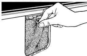
4. Pour placer le filtre à air de remplacement, insérez-le en place.
