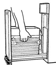
4. Passer l'aspirateur à l'intérieur de la caisse. Les liquides renversés ou les déchets humides doivent être nettoyés à la main ou au moyen d'un aspirateur conçu pour aspirer les liquides.
