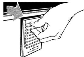
2. Retirer le disque désodorisant, s'il y en a un. Pour commander un nouveau disque désodorisant, composer le numéro sans frais indiqué sur la couverture.
