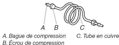
5. Placer l'extrémité libre de la canalisation dans un contenant ou un évier et rétablir l'alimentation principale en eau pour nettoyer le tuyau jusqu'à ce que l'eau soit limpide. Fermer le robinet d'arrêt de la canalisation d'eau.
