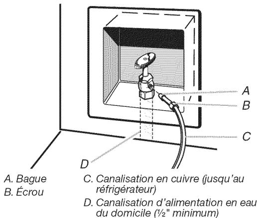
4. On est maintenant prêt à connecter le tuyau en cuivre au robinet d'arrêt. Utiliser un conduit de cuivre flexible de 1/4" (6,35 mm) de diamètre extérieur pour raccorder le robinet d'arrêt au réfrigérateur.
