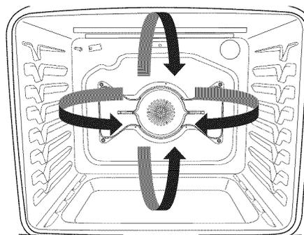
La convection véritable active un élément électrique autour du ventilateur de convection pour améliorer la performance de cuisson. Cette caractéristique permet de cuire les aliments au four sur trois grilles. Utiliser le tableau des options de convection suivant comme guide.
