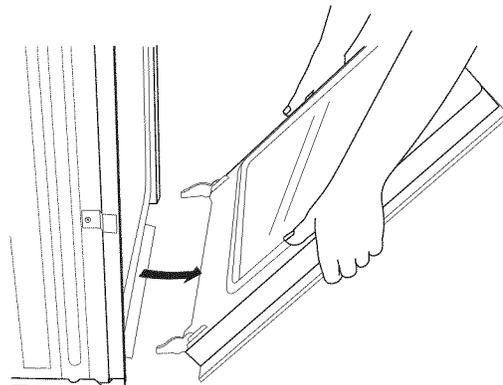
6. Conserver la/les porte(s) du four à part sur la surface de travail couverte en faisant reposer la porte sur sa poignée.
