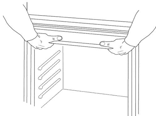
2. Pousser contre la zone du joint du châssis avant pour introduire le four dans le placard, jusqu'à ce que la surface arrière du châssis avant soit au contact de la paroi avant du placard.
