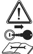
Apague el motor y retire la llave antes de realizar tareas de mantenimiento o reparación
