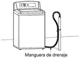
Manguera de drenaje
