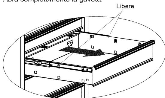
**Estilo palanca** – Levante o baje (dependiendo de la corredera) la palanca de liberación en ambos lados (esto permite que las correderas pasen sobre los topes.) Jale hacia afuera para retirar.
