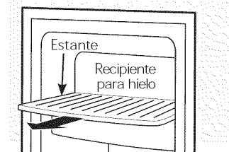
Para alcanzar el interruptor eléctrico.
