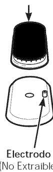
Ensamble de la Cabeza y de la Tapa del Quemador Oval (No Extraíble)
