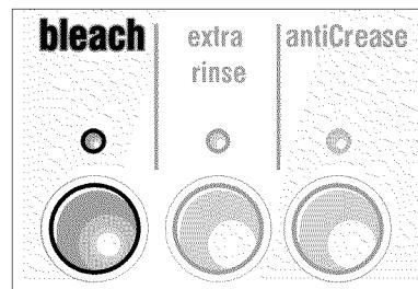
Lorsque vous appuyez sur ce bouton, la machine ajoute un cycle de blanchiment au cycle sélectionné.
