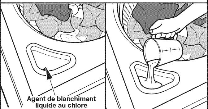
Ne pas remplir excessivement, diluer ou utiliser plus d'une tasse (250 mL). Ne pas utiliser d'agent de blanchiment sans danger pour les couleurs ni de produit Oxi avec un programme utilisant de l'agent de blanchiment au chlore liquide.
