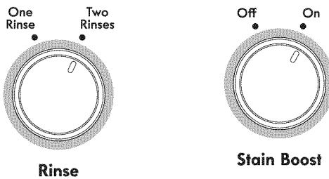
Si l'on souhaite ajouter un Two Rinses (deuxième rinçage) et/ou utiliser l'option STAINBOOST (puissance anti-taches), tourner le bouton correspondant à cette caractéristique.
