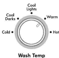
Après avoir sélectionné un programme, sélectionner la température de lavage en tournant le bouton Wash Temp au réglage souhaité.
