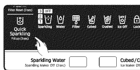
Appuyez sur le bouton Quick Sparkling (Eau pétillante rapide) pendant 3 secondes.
