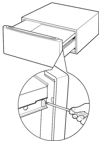
**B** Quite los tornillos de los deslizadores del cajón. Quite el cajón de la base y deje a un costado.
