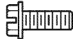
Tornillo hexagonal No 8x3/8 de pulg. (Empacar con el cuberita de portacadena)
