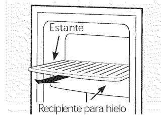
Para llegar al interruptor de corriente.
