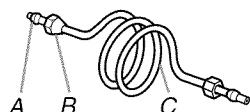
A. Manchon à compression B. Écrou de compression C. Tuyau en cuivre
