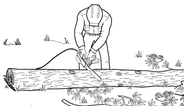
Figure 10 - Tronçonnage d'une bille qui repose entièrement au sol
