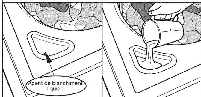
Ne pas remplir excessivement le distributeur ne pas diluer ni utiliser plus de une tasse (250 mL) d'agent de blanchiment liquide au chlore. Ne pas utiliser d'agent de blanchiment sans danger pour les couleurs ni de produit Oxi avec un programme utilisant de l'agent de blanchiment au chlore liquide.
