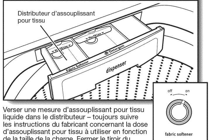
Verser une mesure d'assouplissant pour tissu liquide dans le distributeur – toujours suivre les instructions du fabricant concernant la dose d'assouplissant pour tissu à utiliser en fonction de la taille de la charge. Fermer le tiroir du distributeur, sélectionner ensuite l'option Fabric Softener (assouplissant pour tissu). L'assouplissant pour tissu est ajouté pendant le rinçage.
