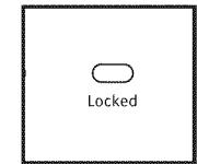
Si l'on doit ouvrir le couvercle, appuyer sur START/Pause (mise en marche/pause). Le couvercle se déverrouille une fois que le mouvement de la laveuse a cessé. Il se peut que cela prenne plusieurs minutes si la laveuse essorait la charge à grande vitesse.
