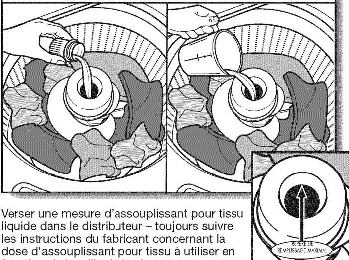
Diluer l'assouplissant pour tissu liquide en remplissant le distributeur d'eau tiède jusqu'à ce que le liquide atteigne la partie inférieure de l'anneau. Voir les flèches du repère de remplissage maximum.
