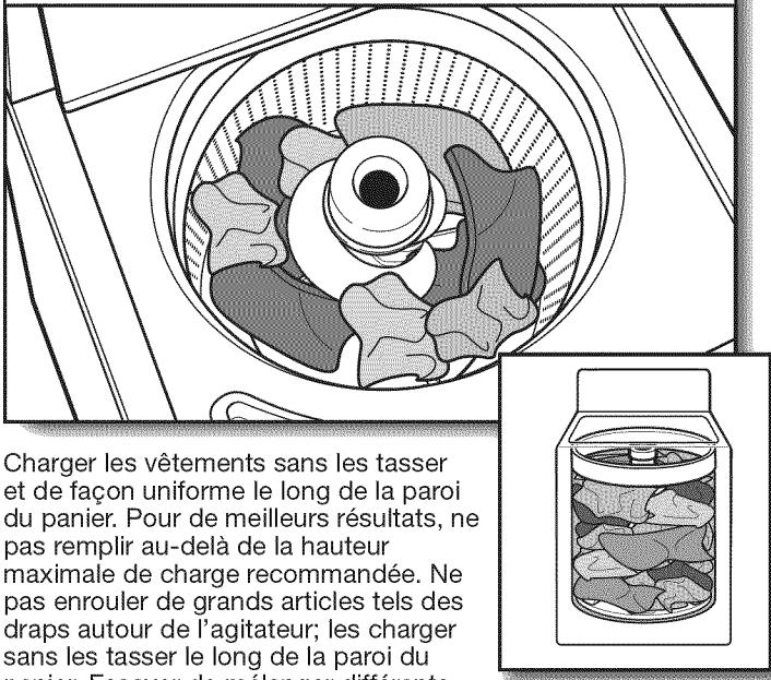
**IMPORTANT :** Ne pas tasser les articles ou les pousser dans la laveuse. Les articles doivent pouvoir se déplacer librement pour un nettoyage optimal et pour réduire le froissement et l'emmèlement.
