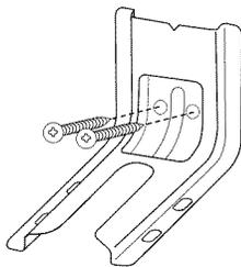
5. À l'aide du tournevis Phillips, monter la bride antibasculement sur le mur ou sur le plancher avec les deux vis n° 12 x  $1\frac{1}{2}$ " (4,1 cm) fournies.
