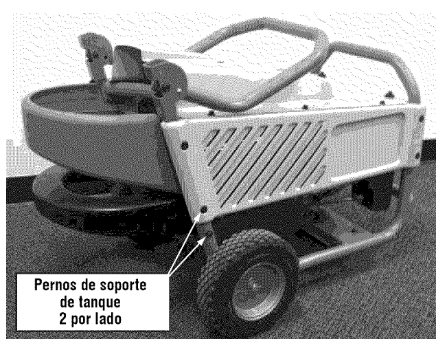
Figura 2 – Ensamble de las ruedas y la manija
