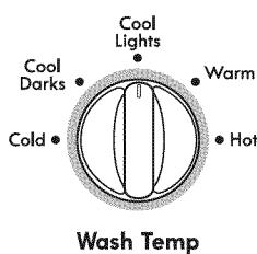
Après avoir sélectionné un programme, sélectionner la température de lavage désirée en tournant le bouton Wash Temp au réglage souhaité.
