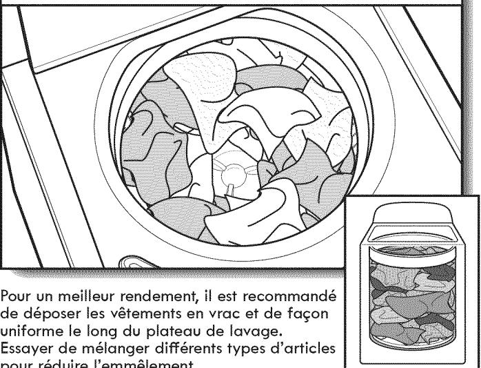
**IMPORTANT :** Ne pas tasser excessivement les vêtements ni les introduire de force dans la laveuse. Les vêtements doivent pouvoir se déplacer librement. Le fait de trop tasser les vêtements pourrait entraîner une mauvaise performance de lavage et augmenter le froissement et l'emmêlement.
