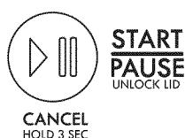
Presione el botón de START/PAUSE/Unlock Lid (Inicio/Pausa/Desbloqueo de la tapa) para comenzar el ciclo de lavado. Cuando haya terminado el ciclo, se encenderá el indicador de CYCLE COMPLETE (Ciclo terminado). Saque las prendas inmediatamente después de que se haya terminado el ciclo para evitar olores, reducir la formación de arrugas y evitar que se herrumbren los ganchos de metal, zípers y broches a presión.
