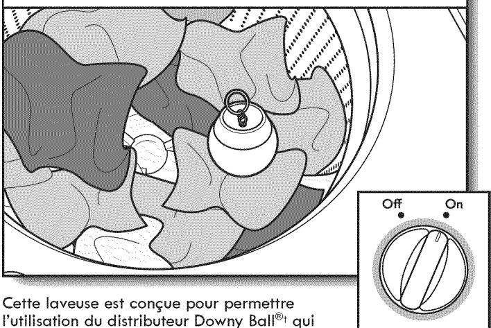
**IMPORTANT :** L'option Fabric Softener doit être réglée sur "On" (marche) pour que le produit soit distribué correctement et au moment adéquat du programme. Ne pas remplir le distributeur excessivement ni diluer le produit.
