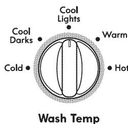
Una vez que haya seleccionado un ciclo, seleccione la temperatura de lavado deseada, girando la perilla de Wash Temp (Temperatura de lavado) hacia el ajuste deseado.
