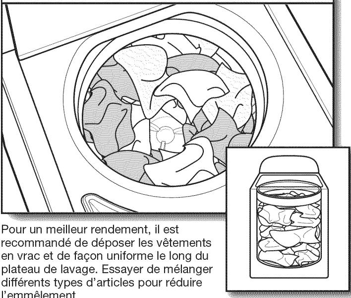
Pour un meilleur rendement, il est recommandé de déposer les vêtements en vrac et de façon uniforme le long du plateau de lavage. Essayer de mélanger différents types d'articles pour réduire l'emmèlement.
