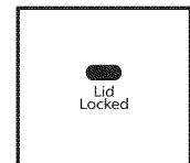
Si l'on doit ouvrir le couvercle, appuyer sur START/Pause (mise en marche/pause). Le couvercle se déverrouille une fois que le mouvement de la laveuse a cessé. Il se peut que cela prenne plusieurs minutes si la laveuse essorait la charge à grande vitesse. Appuyer de nouveau sur START/Pause (mise en marche/pause) pour poursuivre le programme. Éviter d'ouvrir le couvercle durant la détection. Le processus de détection recommencera une fois la laveuse remise en marche.
