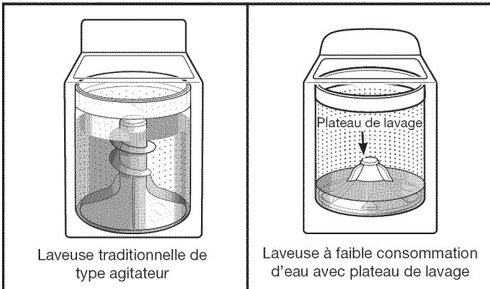
La nouveauté la plus flagrante de cette nouvelle laveuse est son système de lavage à faible consommation d'eau avec plateau de lavage. La laveuse ajuste automatiquement le niveau d'eau en fonction de la taille de la charge — nul besoin de sélecteur de niveau d'eau.
