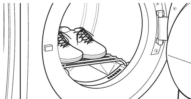
3. Placer les articles mouillés sur la grille de séchage. Laisser suffisamment d'espace entre les articles pour permettre à l'air de circuler. Le tambour tourne, mais la grille ne bouge pas; veiller à laisser suffisamment d'espace entre les articles et à l'intérieur du tambour de la sècheuse. Veiller à ce que les articles ne pendent pas par-dessus les bords de la grille de séchage ou entre les barreaux de la grille.
