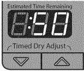
Lorsqu'on sélectionne un programme manuel, la durée par défaut apparaît sur l'affichage. Appuyer sur les boutons ▲ et ▼ pour augmenter ou diminuer la durée par tranches d'une (1) minute. Appuyer sans relâcher pour modifier la durée par tranches de 5 minutes.
