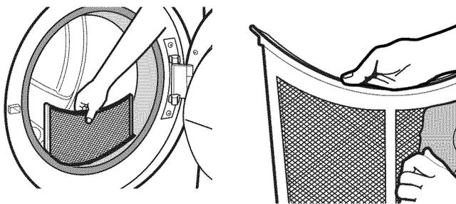
Nettoyer le filtre à charpie avant chaque charge. Enlever le filtre à charpie en le tirant tout droit vers le haut. Enlever la charpie du filtre en la roulant avec les doigts. Ne pas rincer ni laver le filtre pour enlever la charpie. Remettre le filtre à charpie fermement en place.
