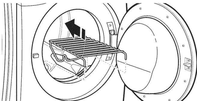
2. Aligner les deux crochets situés à l'avant de la grille de séchage avec les trous situés dans l'ouverture de la porte de la sècheuse et les insérer complètement dans les trous en appuyant. Placer le support arrière sur le rebord arrière de la sècheuse.
