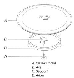
Le plateau rotatif tourne dans les deux sens pour permettre une cuisson plus uniforme. Pour les meilleurs résultats de cuisson, ne pas faire fonctionner le four à micro-ondes sans que le plateau rotatif ne soit en place. Voir "Assistance ou service" pour passer une nouvelle commande de pièces.
