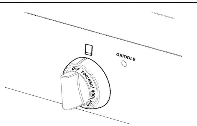
Figure 25 : Bouton de commande de la plaque chauffante
