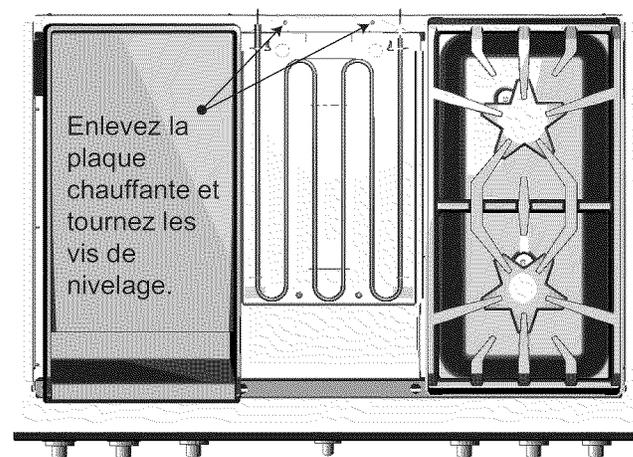
Figure 26 : Vis de nivelage de la plaque chauffante
