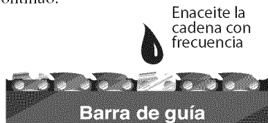
Figura 12 - Aplicación de aceite a la cadena
