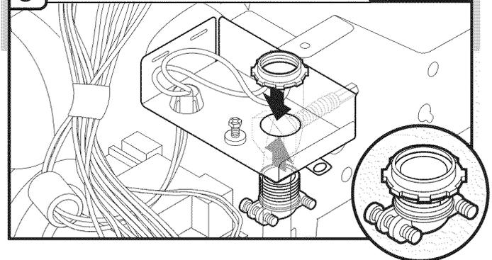
Installer un serre-câble (homologation UL ou CSA). Veiller à ce que les têtes de vis soient orientées vers la gauche après le serrage de l'écrou du conduit. Le serre-câble est fourni avec le cordon d'alimentation.
