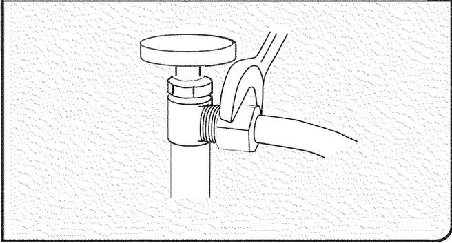
Fixer la canalisation d'alimentation en eau (tube de cuivre ou canalisation flexible à tresse d'acier) à la canalisation d'eau chaude à l'aide d'une configuration de raccordement qui soit conforme à tous les codes et règlements locaux. La canalisation d'alimentation en eau raccordée au lave-vaisselle doit comporter un robinet d'arrêt manuel situé sous l'évier.
