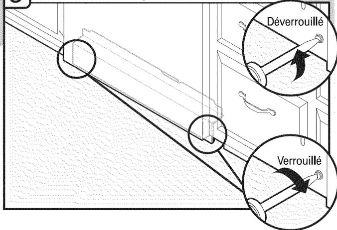
À l'aide d'un tournevis à lame plate, tourner les dispositifs de fixation d'un quart de tour dans le sens horaire pour les emboîter. L'encoche des dispositifs de fixation est complètement à la verticale lorsqu'ils sont correctement emboîtés.
