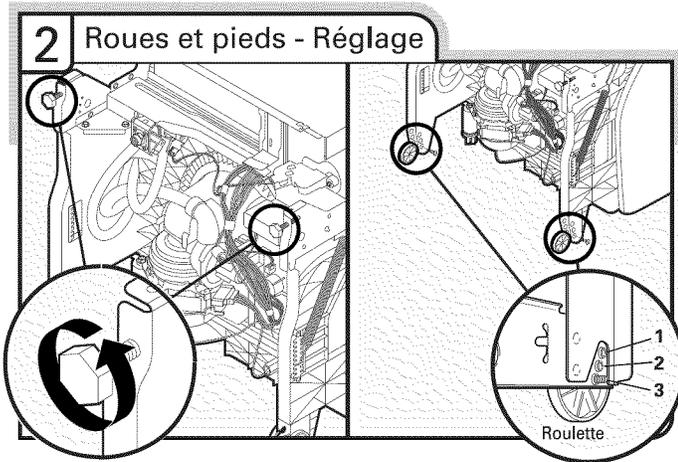
Régler les deux pieds de nivellement à la même hauteur. Placer les roues à la position requise déterminée à partir du "Tableau de réglage de la hauteur du lave-vaisselle".
