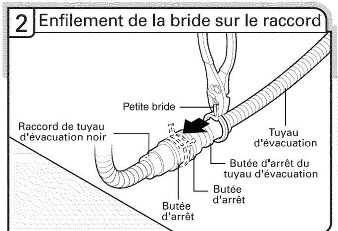
À l'aide d'une pince, ouvrir la petite bride de tuyau d'évacuation en la serrant et la faire glisser sur le connecteur, entre les butées.
