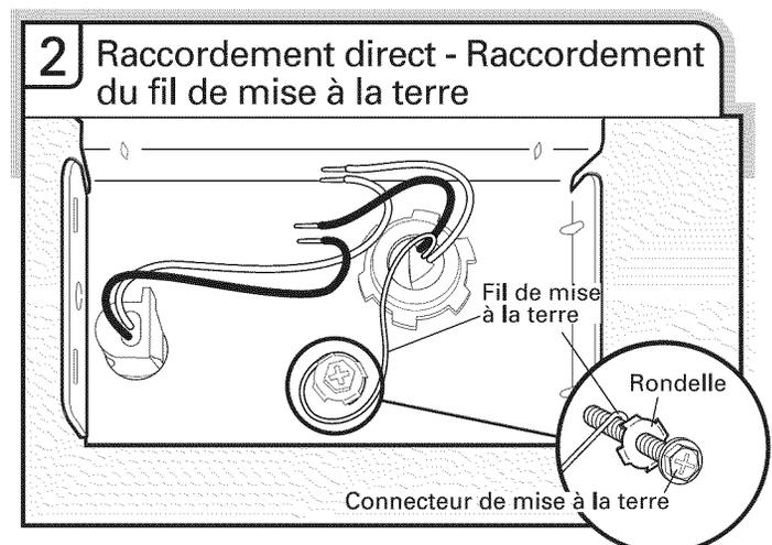
Former un crochet en U avec le conducteur nu de liaison à la terre. Enrouler le crochet du conducteur de liaison à la terre sur la vis de liaison à la terre et sous la rondelle (dans le sens horaire). Serrer fermement le connecteur de liaison à la terre.
