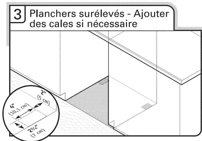
Planchers surélevés : Si la hauteur du plancher de la cuisine est supérieure à celle de l'ouverture d'encastrement du placard. Par exemple, le carrelage du plancher de la cuisine n'arrive pas jusque dans l'ouverture du placard : ajouter des cales selon le besoin dans la zone indiquée pour placer le lave-vaisselle à une hauteur maximale de 34" (86,4 cm) sous le plan de travail.
