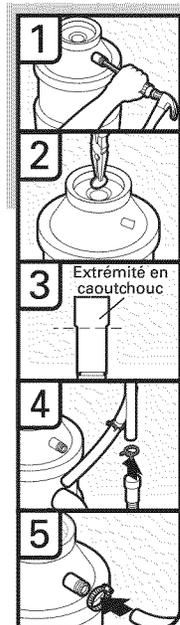
1. À l'aide d'un marteau et d'un tournevis, enfoncer le bouchon d'obturation dans le broyeur à déchets.
