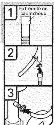
1. Raccorder l'extrémité en caoutchouc du tuyau d'évacuation au dispositif de brise-siphon et couper si nécessaire.
