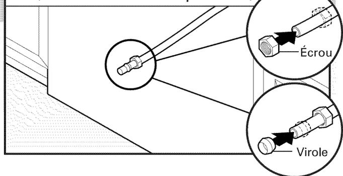
Canalisation en cuivre uniquement : Enfiler l'écrou puis la virole sur la canalisation de cuivre, sur environ 1" (2,5 cm).
