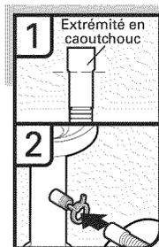
1. Raccorder l'extrémité en caoutchouc du tuyau d'évacuation à la canalisation d'égout en T et couper si nécessaire.
