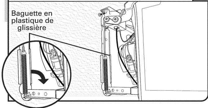
Enlever et jeter la baguette en plastique de glissière de chaque côté du châssis du lave-vaisselle. Pour retirer la baguette en plastique de glissière, la pousser vers le haut puis vers l'arrière et la déboîter du châssis du lave-vaisselle.
