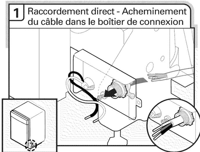
Acheminer le cordon d'alimentation de façon à ce qu'il ne touche ni le moteur du lave-vaisselle, ni la partie inférieure de la cuve du lave-vaisselle. Tirer le câble pour le faire passer à travers le serre-câble (homologation UL/CSA) dans le boîtier de connexion. Le serre-câble n'est pas fourni avec le lave-vaisselle. Le propriétaire doit acheter un serre-câble à vis de 7/8".
