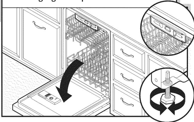
Placer le niveau contre la partie supérieure de l'ouverture avant de la cuve. Vérifier l'aplomb transversal de l'appareil. Si le lave-vaisselle n'est pas d'aplomb, régler la hauteur des pieds avant vers le haut ou vers le bas jusqu'à ce que le lave-vaisselle soit d'aplomb. Fermer la porte du lave-vaisselle.
