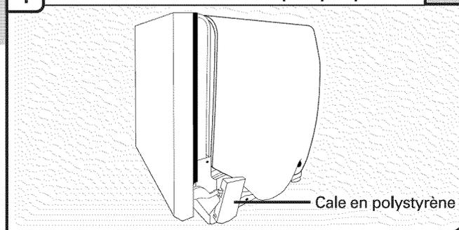
Enlever et jeter les cales en polystyrène situées au-dessus des pieds avants, de chaque côté du lave-vaisselle. Les cales permettent de couvrir les poulies à cordon/chaîne du lave-vaisselle.
