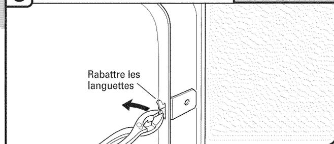
Enfoncer la bride dans la fente sur le côté du lave-vaisselle et replier la languette vers le côté du lave-vaisselle afin de maintenir la bride en place. Répéter cette opération par l'autre côté du lave-vaisselle.
