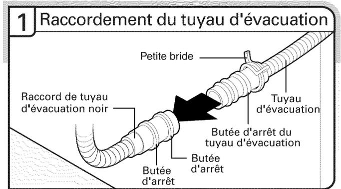
Placer une serviette sous le tuyau d'évacuation pour récupérer l'eau restée dans le tuyau d'évacuation. Placer la petite bride pour tuyau d'évacuation sur la petite extrémité du tuyau d'évacuation. Enfoncer le tuyau d'évacuation neuf dans le connecteur noir de tuyau d'évacuation jusqu'à la butée d'arrêt du tuyau d'évacuation.
