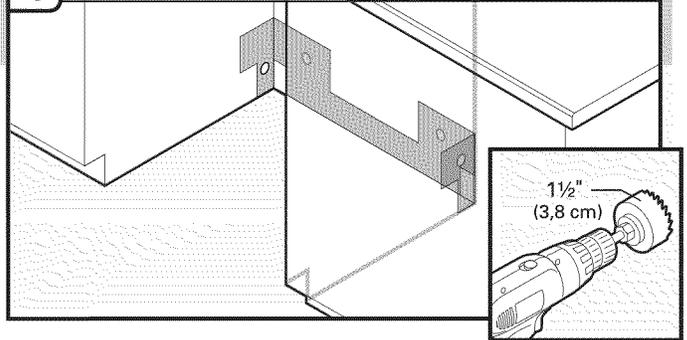
Si nécessaire, percer un trou de 1 1/2" (3,8 cm) de diamètre dans la paroi du placard ou le côté de l'ouverture le plus proche de l'évier.
