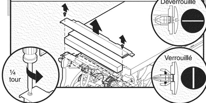
À l'aide d'un tournevis à lame plate, tourner les dispositifs de fixation d'un quart de tour dans le sens antihoraire pour les déverrouiller. Retirer le panneau. Ne pas retirer la fiche technique du panneau d'accès.
