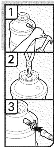
1. À l'aide d'un marteau et d'un tournevis, enfoncer le bouchon d'obturation dans le broyeur à déchets.
