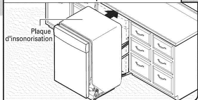
**IMPORTANT :** Si l'on enlève les roulettes, couvrir le plancher lors des déplacements du lave-vaisselle pour ne pas l'endommager. Insérer lentement et complètement le lave-vaisselle dans l'ouverture d'encastrement du placard. Veiller à ne pas coincer ou déformer la canalisation, le tuyau d'évacuation, le cordon d'alimentation ou le câble de raccordement direct entre le lave-vaisselle et le placard. Enlever le carton placé sous le lave-vaisselle.
