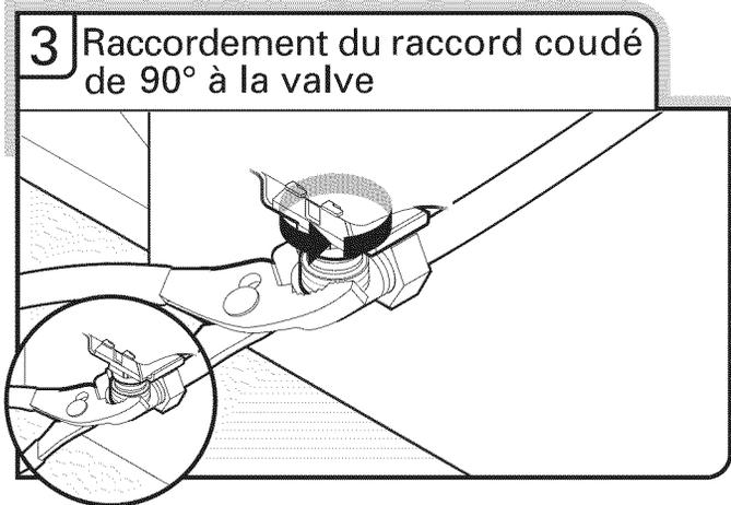
S'assurer que la rondelle de caoutchouc est correctement installée dans le raccord. Enfiler le raccord de 3/4" vers le haut jusqu'à la valve et serrer à la main afin d'éviter de fausser le filetage. Serrer à la main jusqu'à ce que le raccord soit serré.
