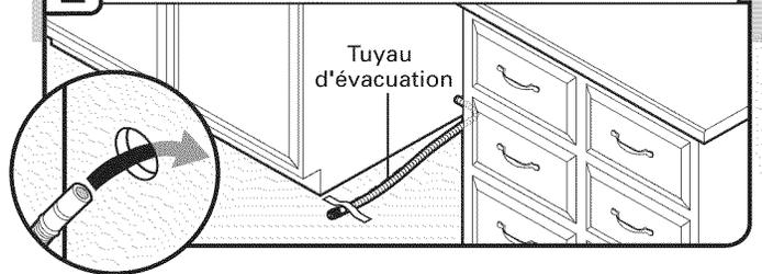
Insérer le tuyau d'évacuation tel qu'indiqué à travers le trou dans le placard et l'acheminer jusqu'au point de raccordement du tuyau d'évacuation (au centre de l'ouverture, à l'avant). Fixer le tuyau d'évacuation au plancher avec du ruban adhésif dans la zone indiquée. Cela l'empêchera de bouger lors de l'insertion du lave-vaisselle dans l'ouverture du placard.
