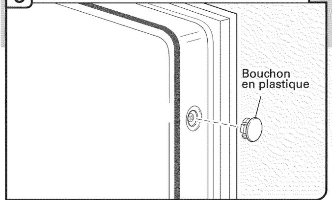
Dans le cas de la fixation sur les placards latéraux, vérifier que les côtés de la porte ne frottent pas contre les têtes de vis. S'il y a frottement, centrer à nouveau le lave-vaisselle. Une fois le lave-vaisselle correctement centré, réinstaller les boutons d'obturation de plastique.
