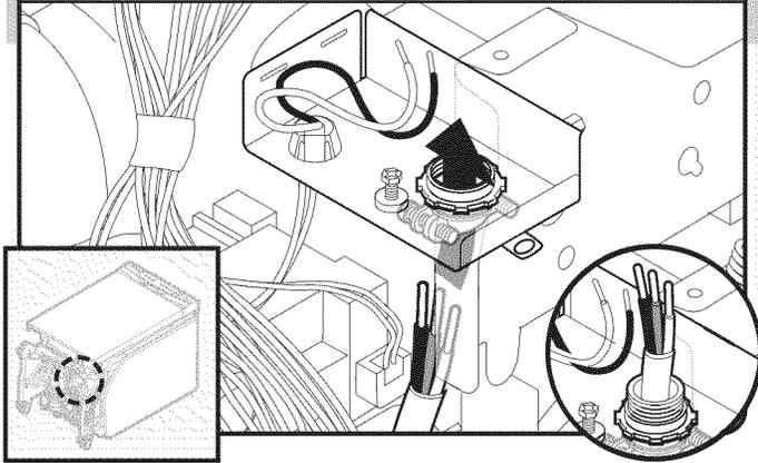
Acheminer le cordon d'alimentation de façon à ce qu'il ne touche pas la zone située entre le moteur du lave-vaisselle et la partie inférieure de la cuve du lave-vaisselle. Tirer le cordon pour l'acheminer à travers le serre-câble dans le boîtier de connexion.
