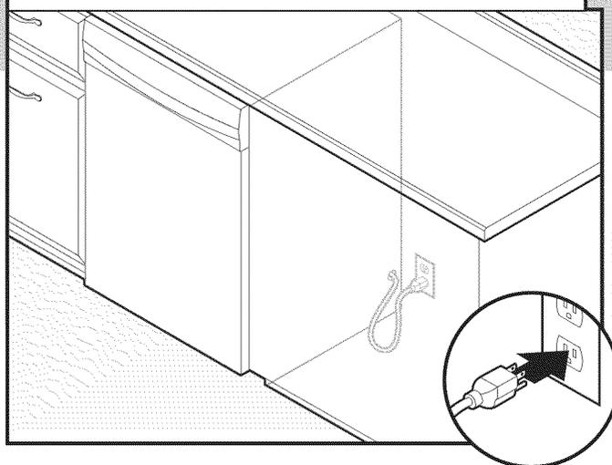
Brancher sur une prise de courant à 3 alvéoles reliée à la terre. Vérifier l'absence de tout contact entre le cordon d'alimentation et le moteur du lave-vaisselle ou la partie inférieure de la cuve du lave-vaisselle.
