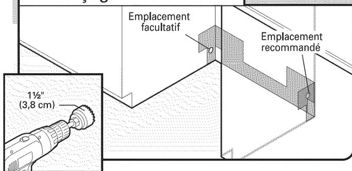
Percer un trou de 1 1/2" (3,8 cm) dans le côté droit de la paroi latérale ou arrière du placard.
