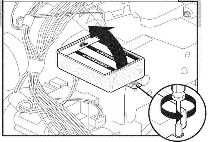
Utiliser une clé à douille hexagonale, un tourne-écrou de 1/4" ou un tournevis Torx® T20®; démonter le couvercle du boîtier de connexion; conserver les pièces pour réutilisation éventuelle.
