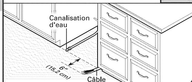
Si la canalisation d'eau et le câble dépassent des emplacements indiqués, passer à la section "Installation du tuyau d'évacuation". S'ils ne sont pas assez longs, suivre les instructions dans la section "Préparation de l'ouverture d'encastrement du placard – Nouveaux moyens de raccordement".
