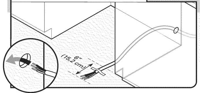
Acheminer le câble de la source d'alimentation électrique à travers le trou dans le placard (le câble doit dépasser par le côté avant droit de l'ouverture d'encastrement du placard). Fixer le câble au plancher avec du ruban adhésif dans la zone indiquée. Cela empêchera le câble de bouger lors de l'insertion du lave-vaisselle dans l'ouverture du placard.
