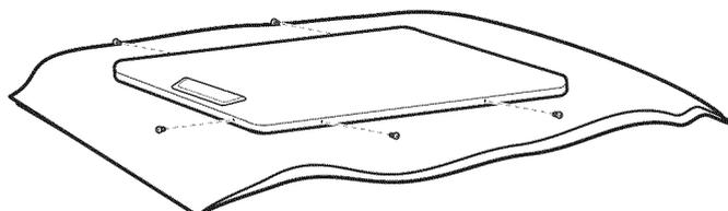
6. Tout en maintenant la porte sur une serviette et sur la sècheuse, saisir les côtés de la porte externe et soulever doucement pour la séparer de la porte interne (ne pas les séparer en forçant). Ne pas tirer sur le joint ou le loquet en plastique de la porte.
