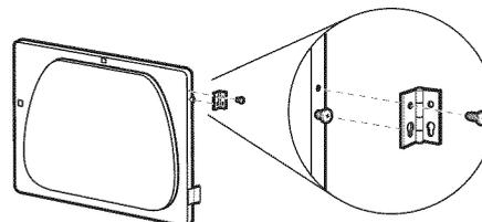
10. Ôter les 4 vis fixant les 2 bouchons d'obturation du côté de la poignée. Fixer les bouchons d'obturation au côté opposé à l'aide des mêmes 4 vis.
