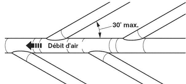
L'inclinaison maximale de chaque conduit qui pénètre dans le conduit principal ne doit pas dépasser 30°.
