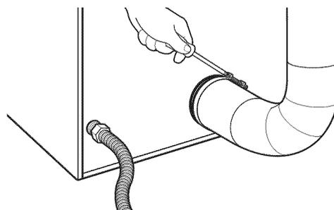
4. S'assurer que le conduit d'évacuation est fixé au clapet d'évacuation à l'aide d'une bride de fixation de 4" (102 mm).
