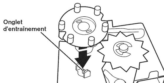
6. Faire tourner la came pour aligner l'encoche en V sous la dent de la roue dentée.
