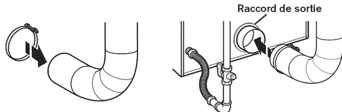
3. Serrer la bride de serrage de tuyau avec un tournevis Phillips.
