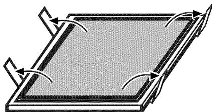
3. Placer le filtre à charbon dans la partie supérieure du filtre métallique.
