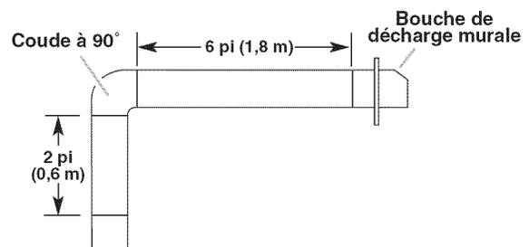
Dans l'exemple suivant, la longueur théorique du circuit est inférieure au maximum recommandé de 35 pi (10,7 m).
